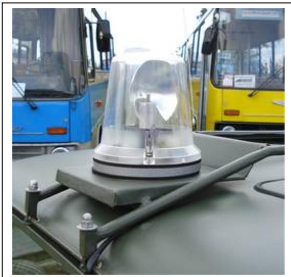
**Abb.:** Weiße Variante der von FER- Ruhla hergestellten Rundumleuchte M 8563.5
