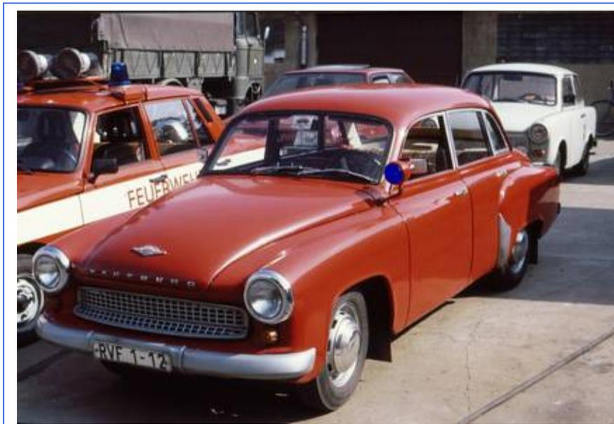
Abb.: Wartburg 311 Limousine, als ELW. Das Kennlicht war am A-Holm der Fahrerseite angebracht.
