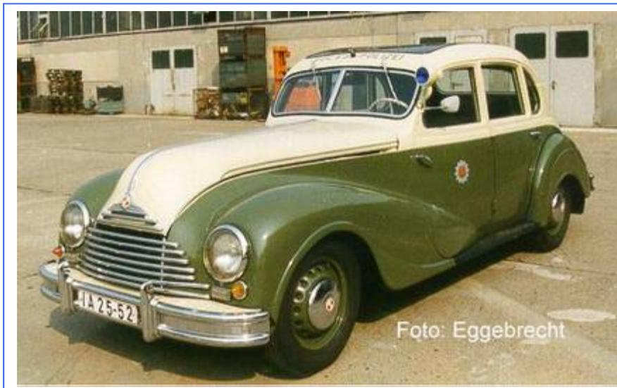
Abb.: EMW 340 Limousine der Volkspolizei mit einem Kennscheinwerfer am linken A-Holm befestigt.
